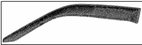
图 4 拼接完整的汽车防雨板点云
